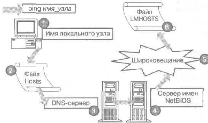
Рис. 6-3. Резервные способы разрешения имен
