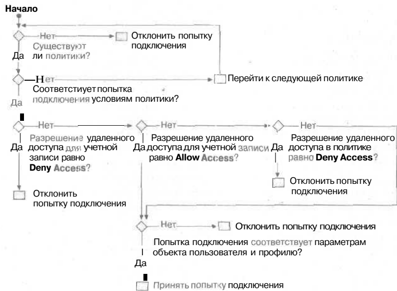
Рис. 11-6. Схема применения политики удаленного доступа
