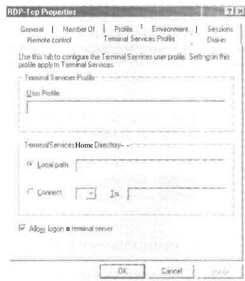
Рис. 4-7. Предоставление доступа к серверу терминалов
