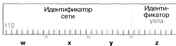
Рис. 2-6. Установка бит для каждого класса IP-адреса
