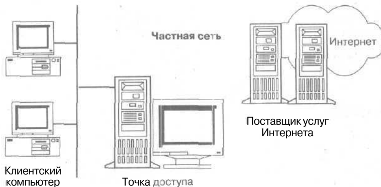
Рис. 1-4. Подключение частной сети к Интернету
