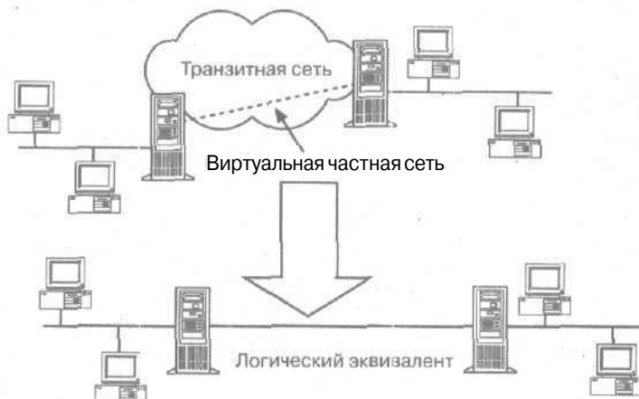
Рис. 11-15. Схема виртуальной частной сети
