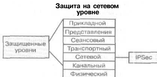
Рис. 5-1, Защита на сетевом уровне
