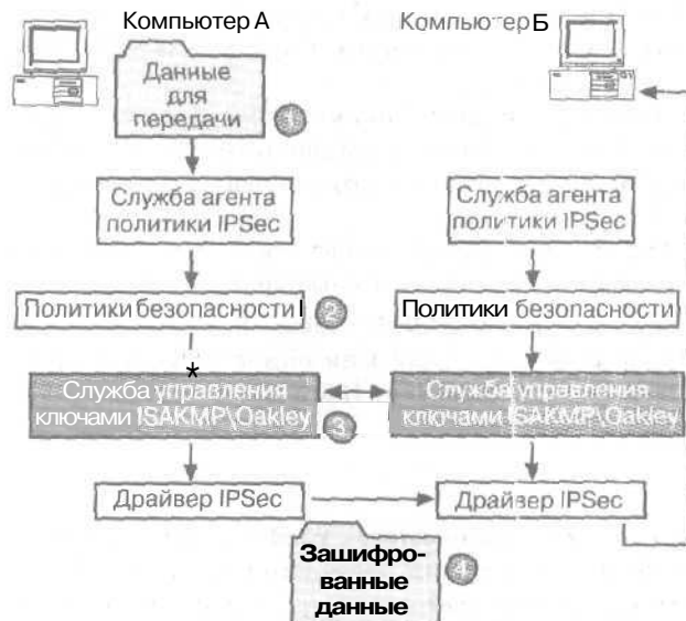
Рис. 5-4. Процесс шифрования данных, пересылаемых между компьютерами с использованием протокола IPSec
