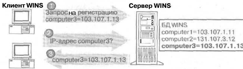
Рис. 9-3. Разрешение имен с использованием WINS
